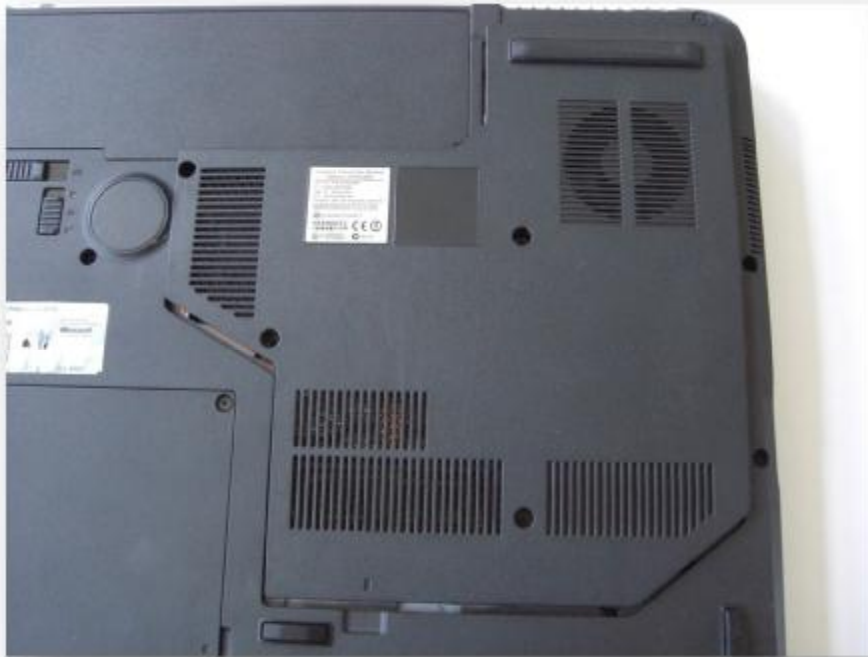
5 Möglichkeit der Säuberung der Lüftungswege (Bild: Dr. Brüning Engineering)
