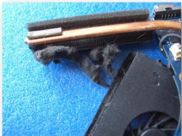
3 Verstopfte Lüftungswege (Bildquelle: Dr. Brüning Engineering)
