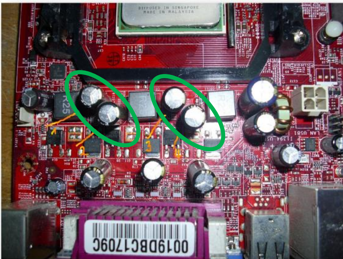
8 defekte Kondensatoren auf dem Mainboard (Bild: Lokale Agenda 21)
